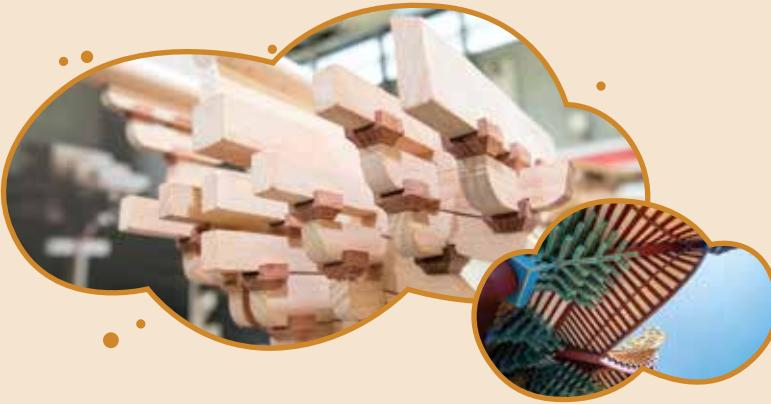
在這個工作坊中，你將化身古代工匠，親手參與「四鋪作插昂補間鋪作」模型製作，從切割、拼砌到合力完成成品，體驗古建築中榫卯結構的精妙設計。課程結合《營造法式》文化背景，讓你在動手中理解中國建築之美與科學之理，並可帶走親製的迷你斗拱，作為珍貴紀念。
